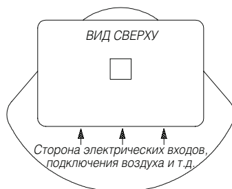
РИСУНОК 1. Среднее положение квадрата привода и корпуса позиционера
